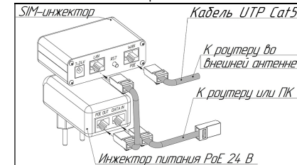
Схема 2 – PoE подключение SIM-инжектора
