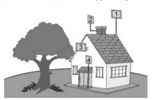
Желательно установить гермобокс в прямой видимости базовой станции оператора связи. На пути от роутера до базовой станции не должно быть никаких близко стоящих высоких препятствий или других антенн. Здания, горы, холмы, лесопосадки мешают распространению сигнала. Устанавливайте гермобокс как можно выше.
