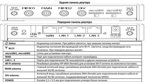
Кнопка сброса устройства Reset. Нажатие кнопки длительностью до 5 секунд приведет к
