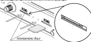
Установку SIM-карты в слот необходимо производить с небольшим усилием, дальше передней панели роутера до характерного щелчка. Не допускается использование острых предметов (игла, пинцет и т. д.) для установки SIM-карты, в виду возможной деформации разъёма.
